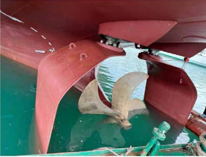
Şekil 4: ERGE gemisi GATE dümen sistemi
