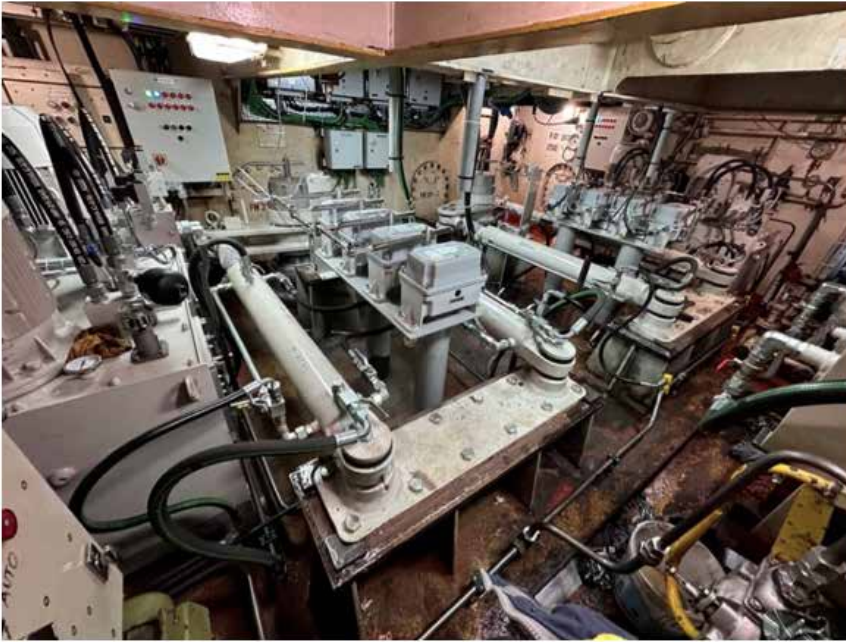
Şekil 5: GATE tipi dümen için çift dümen makinası ile donatılmış dümen dairesi
