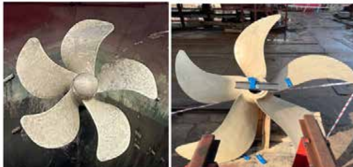
Şekil 3: ERGE gemisi orijinal ve GATE dümen için optimize edilmiş pervaneleri
