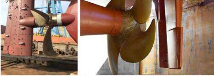
Şekil 9: Dümen-Pervane entegrasyonu ve bükümlü dümen
