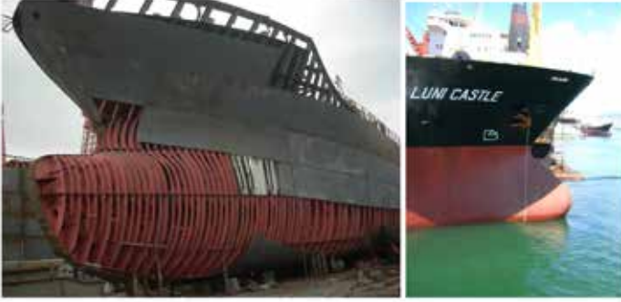
Şekil 5: Tekne form optimizasyonu ve balblı baş formu
