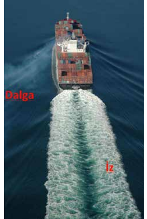
Şekil 2: Gemi hareketi dolayısıyla enerji kayıpları
