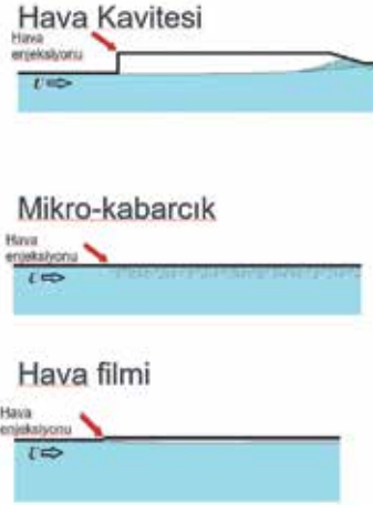
Şekil 3: Hava kavitesi, mikro-kabarcık ve hava filmi
