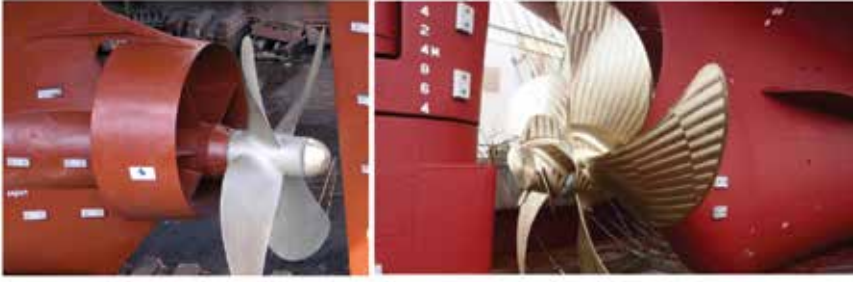
Şekil 8 : Ön girdap yaratıcılı (Mewis duct) ve arka girdap yaratıcılı (Boss cap fin) pervane
